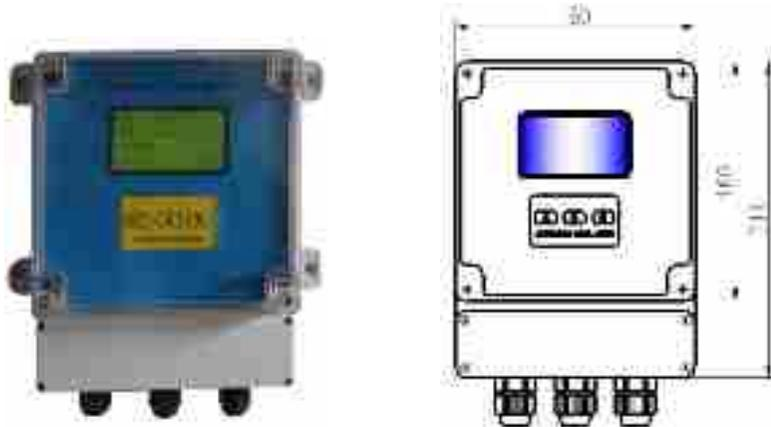
流量计的仪表显示部分应安装在室内。室内要通风良好，无腐蚀性气体。仪表为壁挂安装。如室内条件不好或必须挂在室外，应装在仪表防护箱内，避免日晒雨淋。
