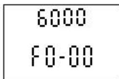
例如：连续按上键 6 次，输入数字 6，第一位输入完毕，再按右移键，光标右移（可以修改的数字右移），如左图
