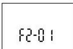
按照步骤 1 的操作输入第二级密码(默认密码 1234)，按确认键后进入参数设置状态如左图，F2-01 表示菜单 2-1，具体菜单目录见菜单列表，按上键进行菜单的选择，例如 MODBUS 通讯板，翻至 F2-03 菜单为流量零点，再按确认键进入菜单修改状态，如下图：
